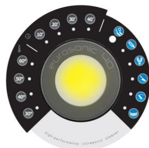
Gelbes, blinkendes Licht: Die Temperatur der Flüssigkeit im Behälter ist zu hoch für den gewählten Zyklus. Die Kühlung abwarten.
